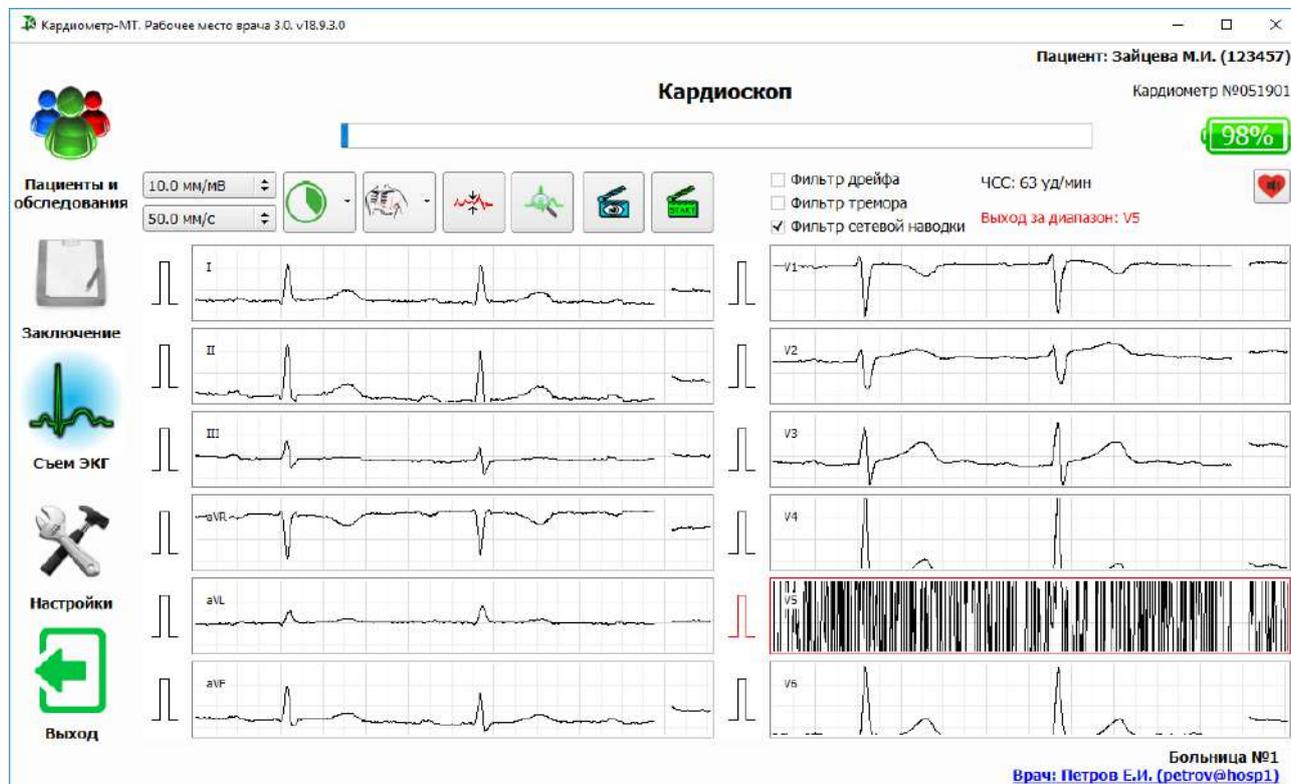
Рис. 10.5: Индикация перегрузки в отведениях
