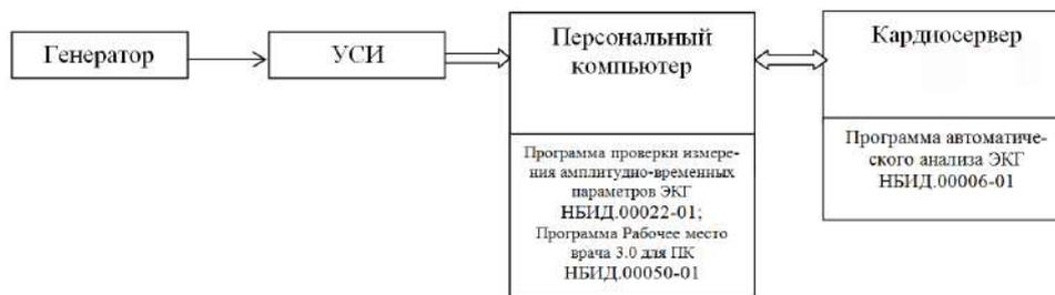
Рис. 16.1: Схема съема, передачи, обработки и отображения метрологической информации
